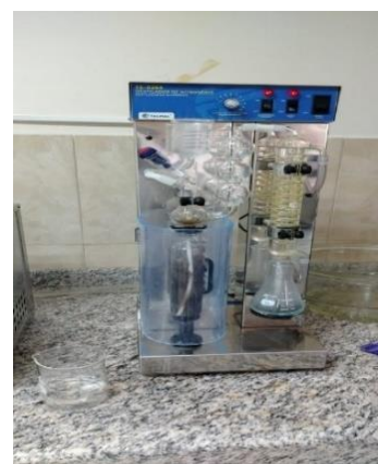
Figura 33. Determinación de Proteínas por el método de Kjeldahl
