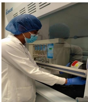
Figura 32. Determinación de grasas por el método de Soxhlet
