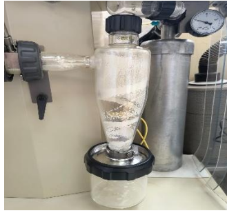
Figura 36. Proceso de microencapsulación en el equipo Buchi Mini Spray Dryer B-290
