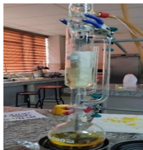
Figura 20. Extracción de luteína con método Soxhlet de la muestra de zuquini deshidratado
