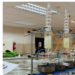
Figura 21. Extracción de luteína con método Soxhlet de la muestra de zuquini fresco
