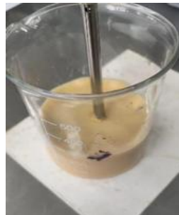
Figura 33. Adición de la fase oleosa sobre la acuosa
