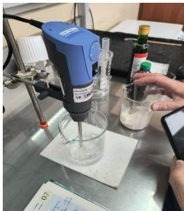
Figura 32. Emulsión de agua con maltodextrina y goma arábica
