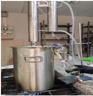
Figura 13. Extracción de luteína por método de arrastre de vapor
