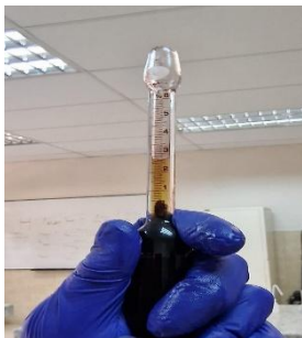
Figura 55. Lectura del butirómetro
