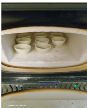
Figura 10. Análisis de ceniza de la materia prima (zuquini)
