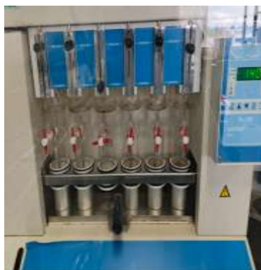
Figura 16. Precalentar el equipo a 140 °C y colocar los dedos en inmersión por 3 h. Pasar a la posición de lavado por 1 h, y recuperación 37 min.
