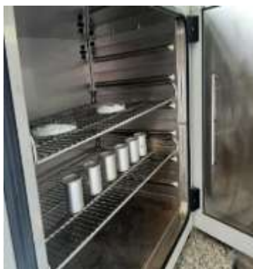
Figura 17. Secar los vasos de extracción en la estufa a 105 °C por 2 h
