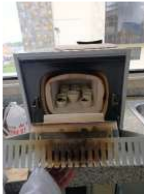
Figura 5. Obtención de cenizas en mufla a 550 ° C por 2 h
