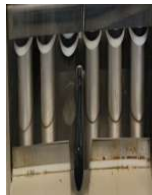
Figura 15. Pesar 60 mL de hexano y colocar al vaso de extracción
