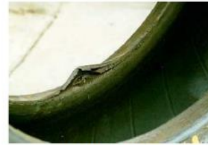
FIGURA 7. Daños en el aro
