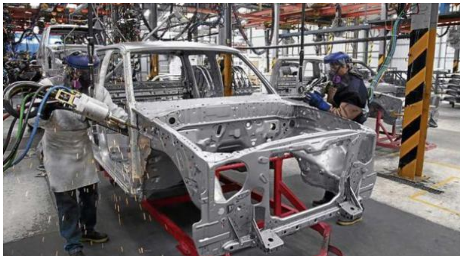
Figura 23: Proceso de acabado metálico
