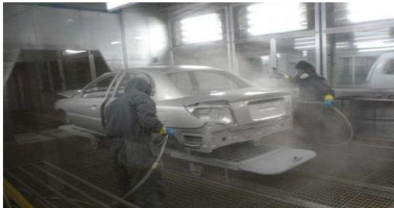
Figura 27: Aplicación de base y brillo
