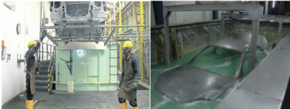
Figura 24: Fondo anticorrosivo por electrodeposición (ELPO)
