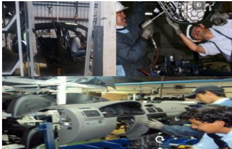
Figura 30: Ensamblaje del vehículo KIA, subida de motor, colocación de tablero, entre otros.
