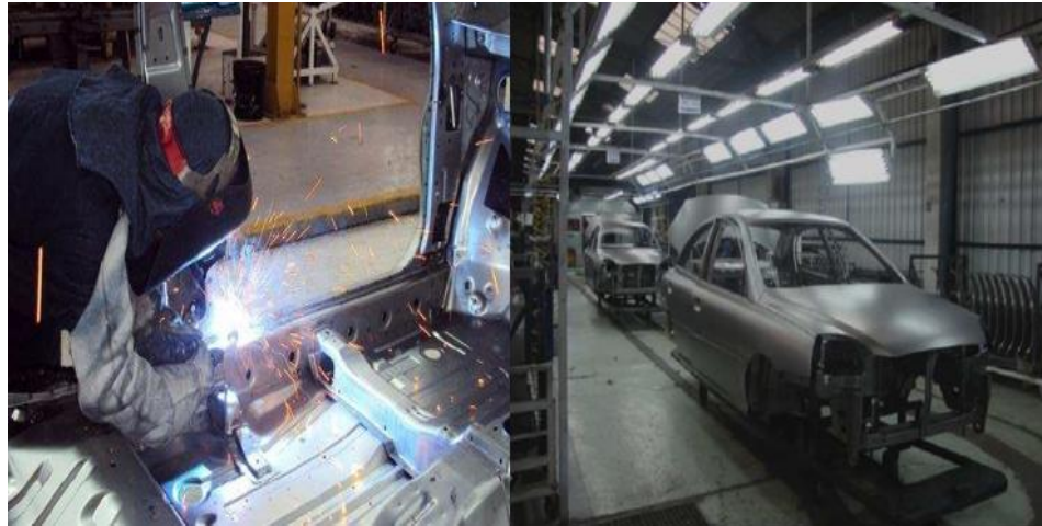
Figura 22: Proceso de soldadura de punto
