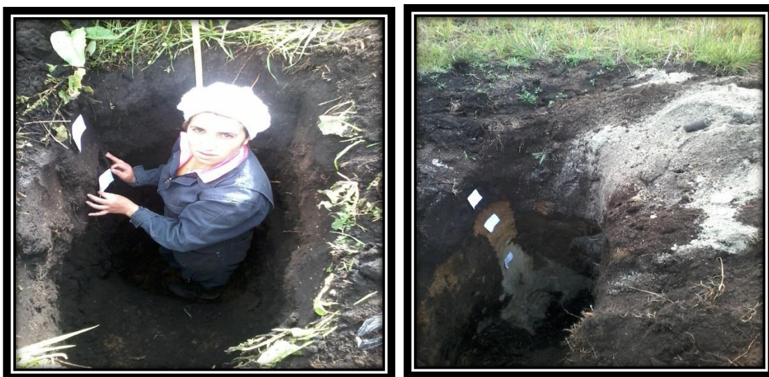
Figura 23: Toma de muestras de calicatas.
