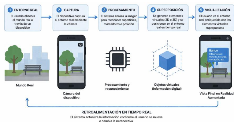
Figura 1. Esquema de Funcionamiento Básico de la Realidad Aumentada
