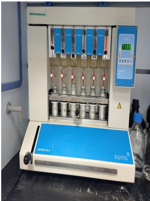
Figura 13. Determinación de grasa en el equipo Soxhlet.
