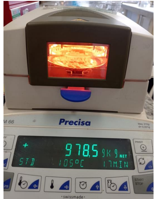
Figura 12. Determinación de humedad en balanza infrarroja.
