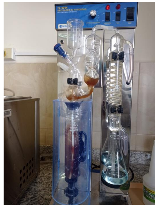
Figura 14. Determinación de proteína en el equipo Kjeldahl.
