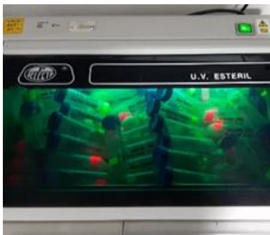
Figura 35. Aplicación de rayos UV para la eliminación de todos los microorganismos presentes
