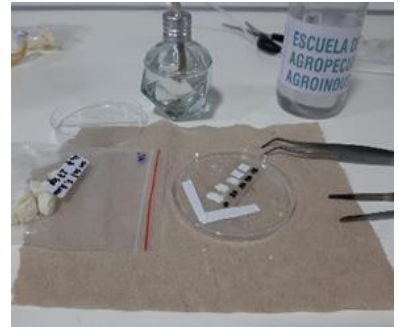
Figura 43. Preparación de las muestras sobre un portaobjetos para llevar a espectrofotómetro de Raman
