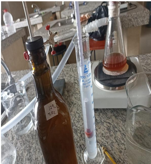
Figura 29. Medición del grado alcohólico del mejor tratamiento por medio de alcoholímetro Gay Lussac
