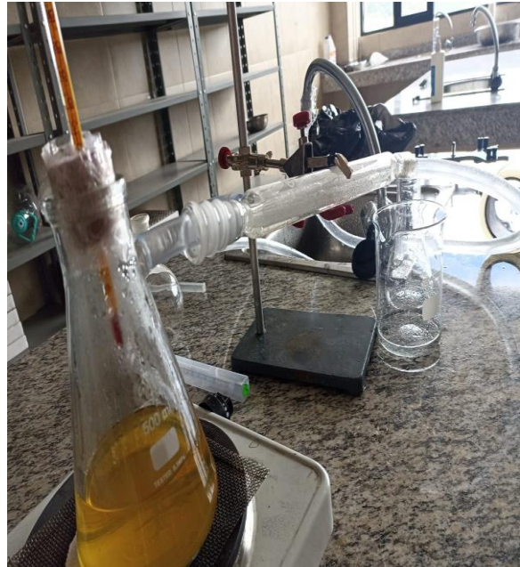
Figura 28. Destilación de vino para el análisis del grado alcohólico
