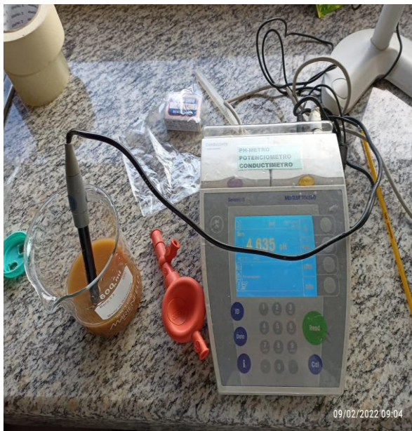
Figura 17. Medición de pH por medio de potenciómetro de pulpa de níspero licuado
