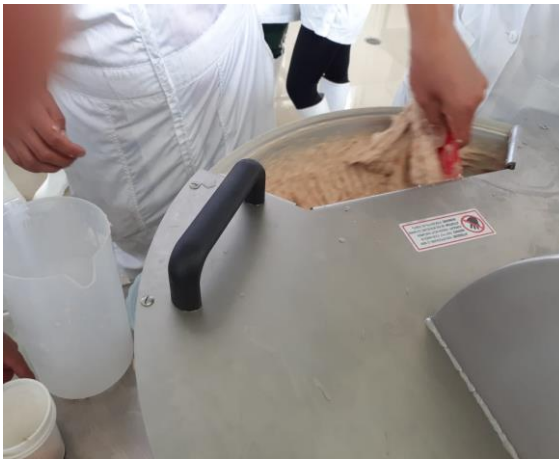
Figura 23. Emulsión de pasta en el cutter.
