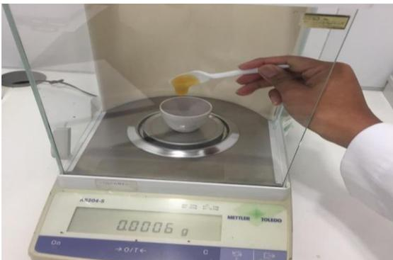
**Figura 29.** Preparación de la muestra para análisis de cenizas
