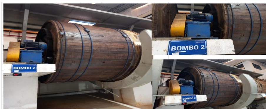
Figura 11. Bombo 2 para mezclado de carnazas de 3500Kgs Fuente: ANDESFOODS CIA. LTDA., (2024)
