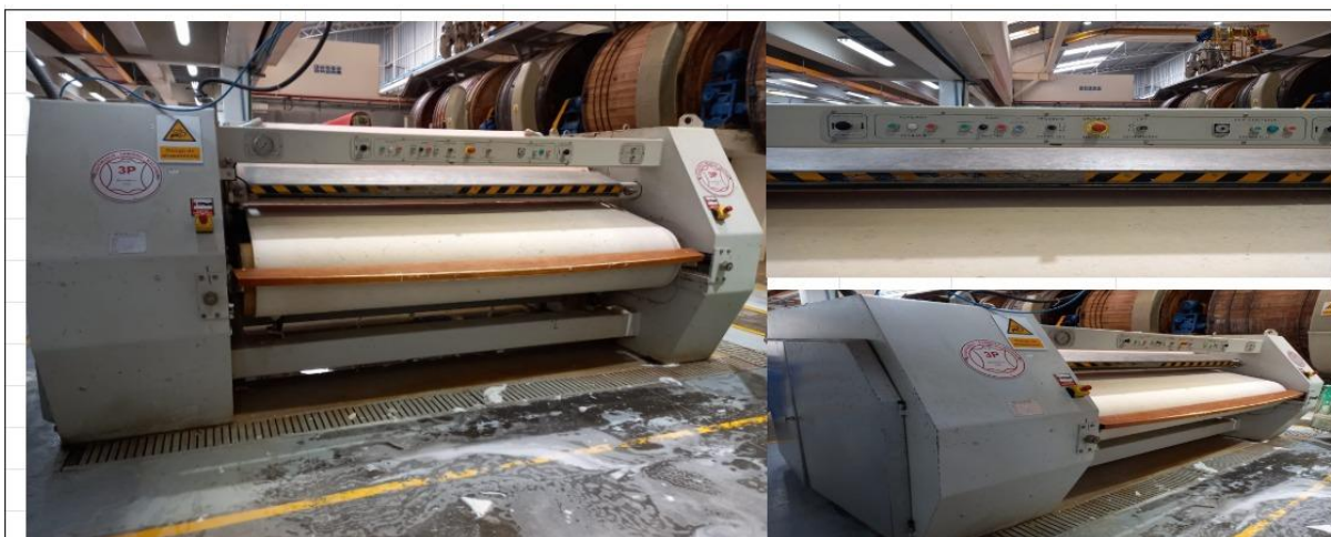
Figura 12. Ecurridora 3P. Capacidad de 1 tonelada. Fuente: ANDESFOODS CIA. LTDA., (2024)
