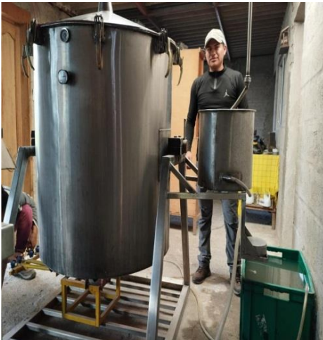
Figura 4. Equipo de destilación
