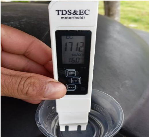
Figura 10. Ajuste del CE de la solución.
