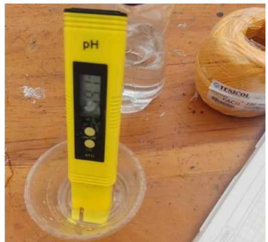
Figura 9. Ajuste del pH de la solución.
