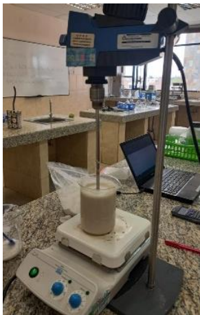
Figura 12. Homogenización 200 rpm a 90°C
