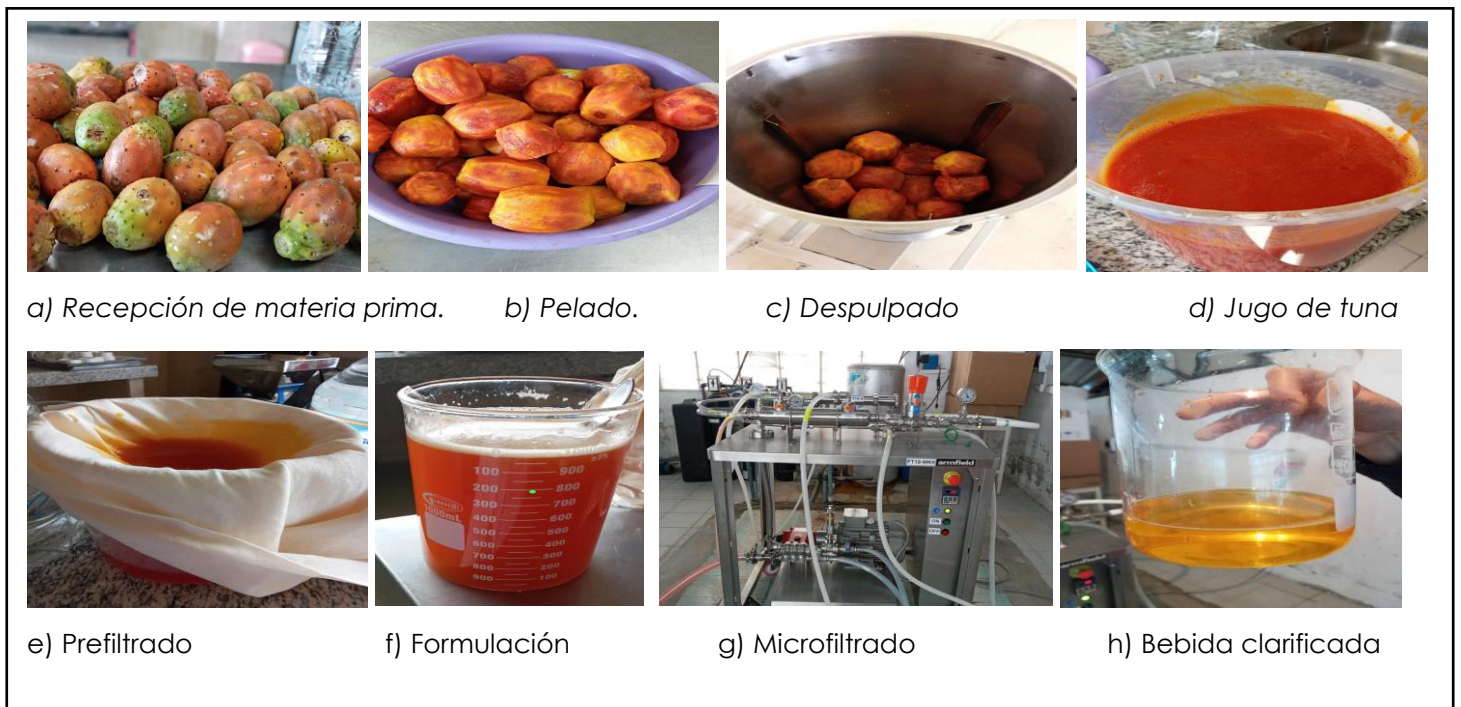
Figura 6. Elaboración de la bebida de tuna: a) Recepción de materia prima. b) Pelado. c) Despulpado. d) Jugo de tuna. e) Prefiltrado. f) Formulación. G) Microfiltrado. H) Bebida clarificada.
