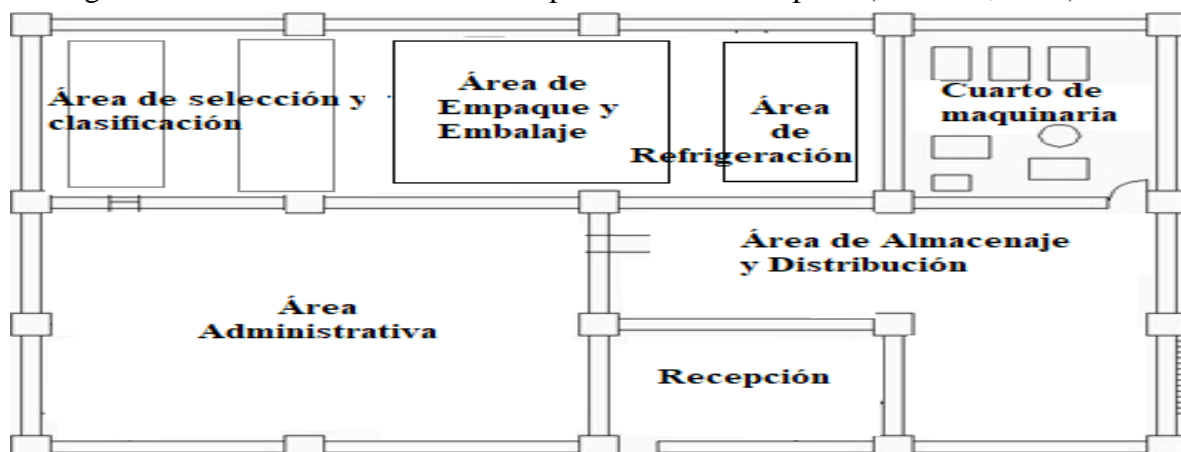
Ilustración 8 Distribución de la planta
