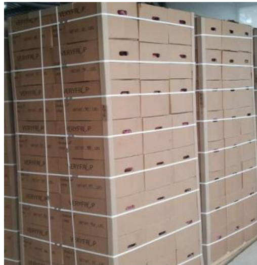
Figura 43: Carga paletizada con fleje y esquineros
