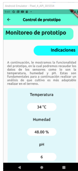
Figura 36. Prueba de lectura de datos de la red de sensores en la aplicación.
