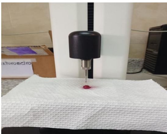
Figura 12. Determinación de fuerza de ruptura.
