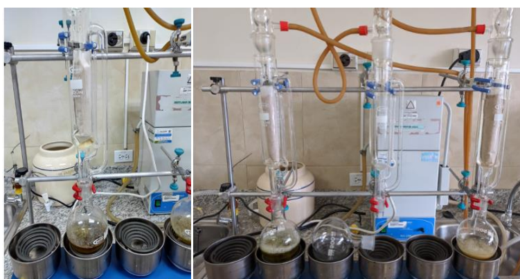
Anexo 4. Extracción sólido-líquido por método Soxhlet. Fuente: Amuy, J. 2023
